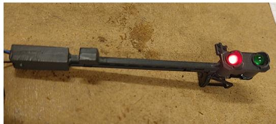
🇫🇷 8. Remonter le garde-corps retiré à l'étape 3. Le signal est prêt. Il peut être fixé librement sur le plateau du réseau. En éliminant tous les équipements électriques, il est possible de le fixer à l'ancienne base, qui reste plate et peut être recouverte de végétation ou d'autres éléments.
