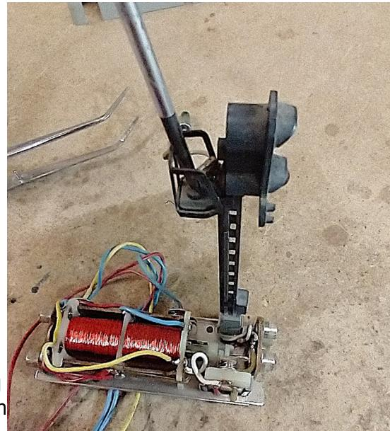
🇫🇷 4. Dévisser la vis qui fixe le signal à sa base. Couper et éliminer les fils gris qui montent sur la structure pour alimenter les ampoules.
