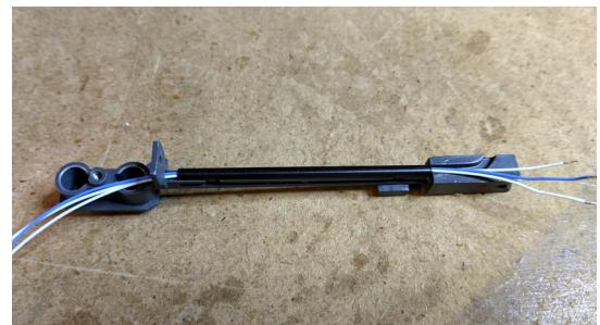
🇫🇷 6. Insérer les deux LED dans les logements où étaient auparavant placées les ampoules. La LED verte va en haut, la LED rouge va en bas.
