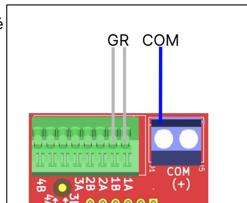
France Pour connecter le signal à une section isolée, afin d'arrêter le train en mode analogique, il est possible d'utiliser les relais GBR40 en réutilisant les câbles rouges d'origine avec leurs cosses métalliques.
