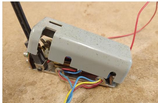
France: 2. Dévisser la vis de fixation de la plaquette située à l'arrière des ampoules. Couper les fils. La plaquette, les fils et les ampoules peuvent être éliminés. Conserver la vis.
